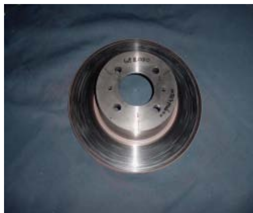
Disco defectuoso debido a los depósitos de material dejado por las pastillas.
