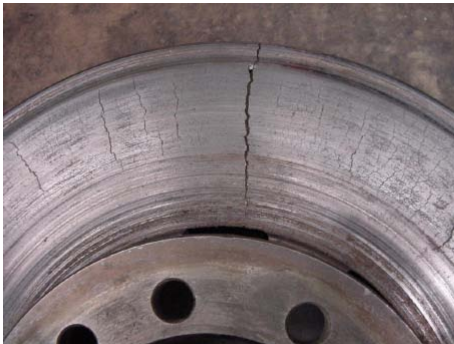
Disco defectuoso por un la aparición de grietas.
