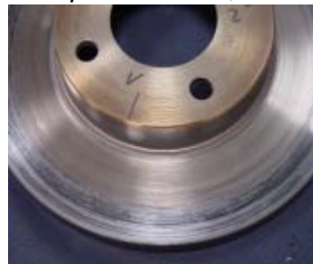
Disco defectuoso por la mala calidad del material de fricción.
