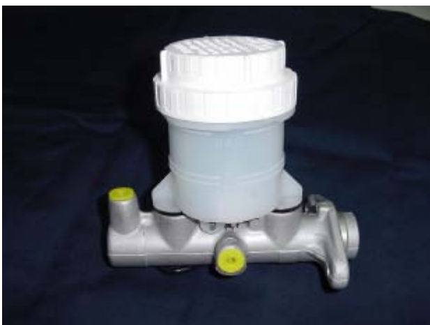
Bomba de freno con depósito para el líquido de frenos
