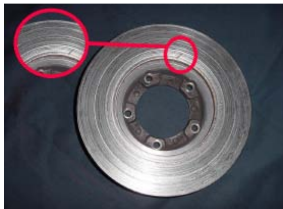
Disco defectuoso por holguras en los rodamientos.
