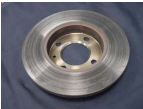
Disco defectuoso por mal montaje de la pinza.
