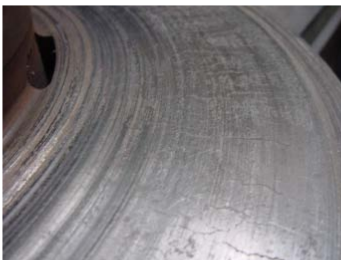
Disco defectuoso por un excesivo superior a su límite máximo.
