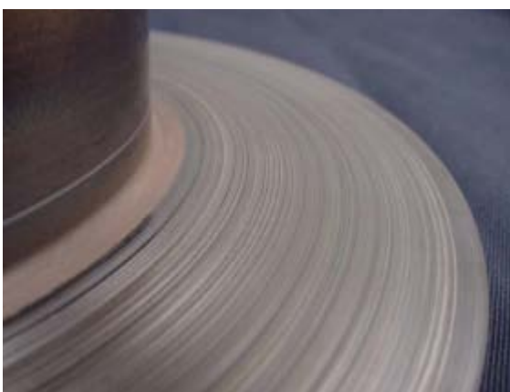
Discos defectuosos por la generación de surcos y grietas profundas.
