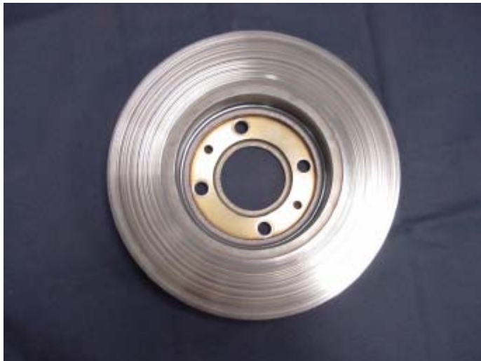
Disco defectuoso por el desgaste total de las pastillas.
